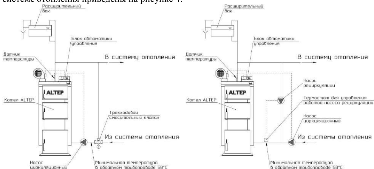
Рисунок 4 - Схемы подключения котла к системе отопления
