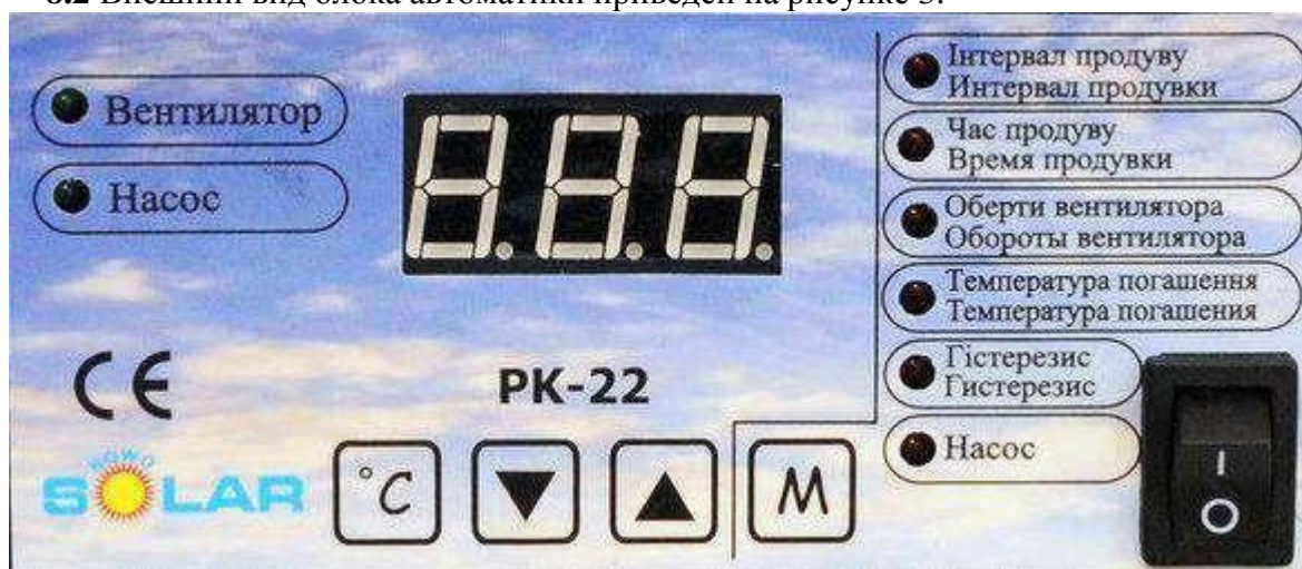
Рисунок 3 - Внешний вид передней панели контроллера
