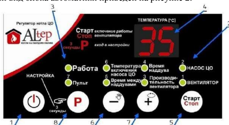
Рисунок 2 - Внешний вид передней панели контроллера
