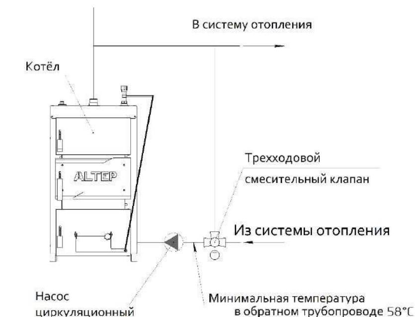
Рисунок 4 - Схемы подключения котла к системе отопления
